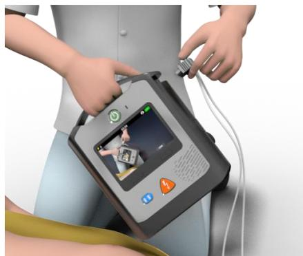
Figura 3-4 Insertar el conector de Los Parches
